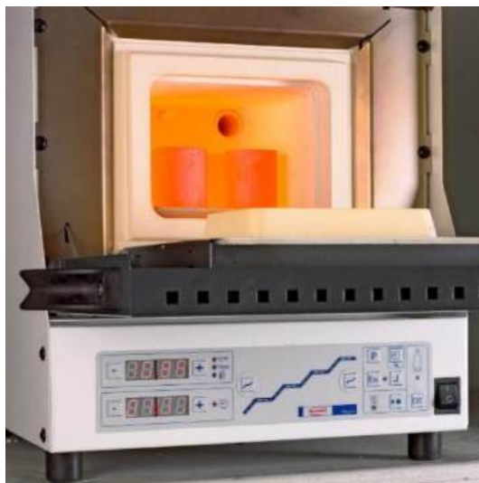
Figura 5. Aquecimento do bloco de revestimento para eliminação da cera
