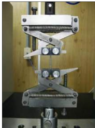
Figura 10. Ensaio de tração na Máquina Universal de Ensaio
