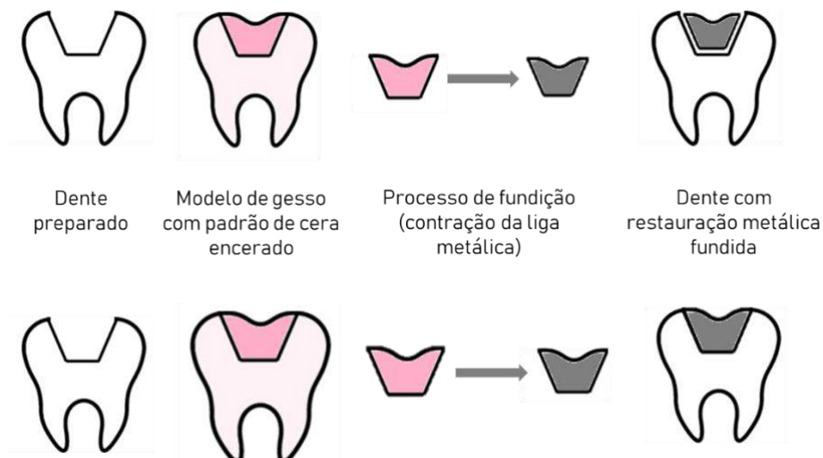
Figura 1. Representação esquemática da adaptação de uma peça metálica fundida (restauração metálica fundida) com o uso de gesso sem expansão de presa controlada (primeira linha) e gesso com expansão de presa controlada (segunda linha)
