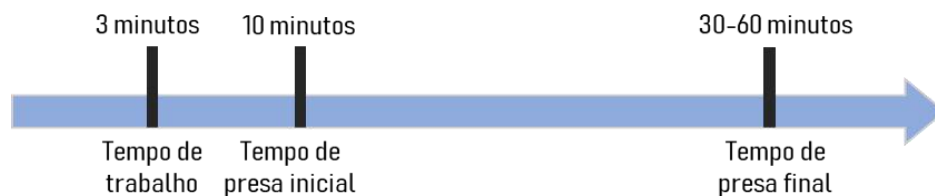
Figura 4. Ilustração esquemática dos tempos médio de trabalho, de presa inicial e de presa final dos gessos odontológicos
