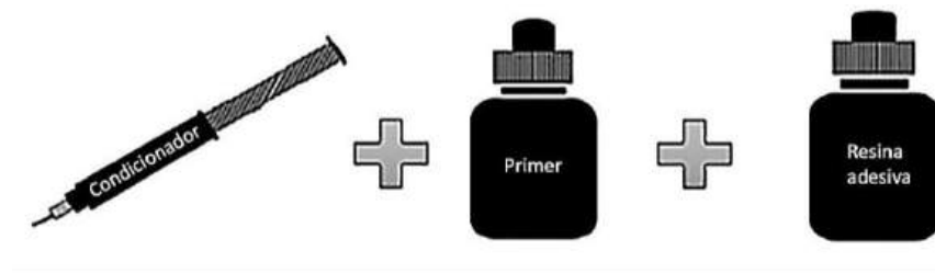
Figura 3. Sistema adesivo convencional de três passos
