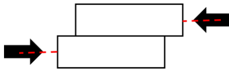
Figura 3. Esquema de forças na tensão de cisalhamento
